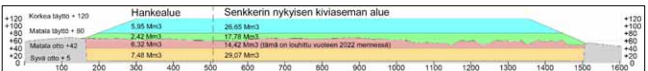
Kuva 1.6. Poikkileikkaus B-B. Kuvaan on täydennetty eri kerrosten tilavuudet. Bild 1.6. Tvärsnitt B-B. Volymerna för de olika skikten har kompletterats på bilden.
