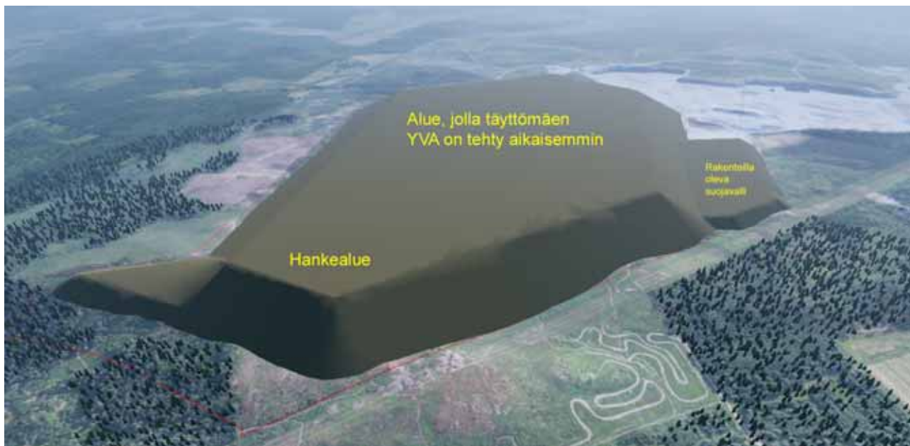
Kuva 1.3. Havainnekuva virtuaalimallista, jossa on esitetty täyttömäki korkeimman vaihtoehdon (+120 m mpy) mukaisesti. Hankealue käsittää täyttömäen etuosan, joka on yhdistetty takaosaan, jonka täyttömäestä on tehty YVA-aikaisemmin. Kuvan oikeassa reunassa näkyy Koivikon asunalueen reuna.
